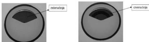
Sl. 6. Pokazivač stanja kočnice – pozicija „zakочено“
